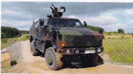
ATF Dingo 2, 160 kW, 218 PS, max. 89 km/h, Leergewicht 12.380 kg, Zul. Gesamtgewicht 18.500 kg
