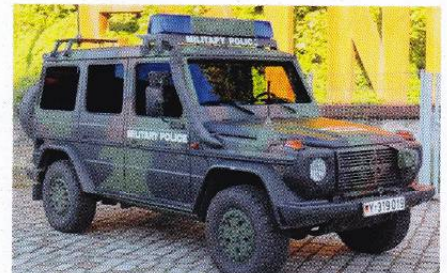
Wolf/Greenliner, 135 kW, 184 PS, Rundumkennleuchte Blau, Funkrucksatz SEM 80/90
