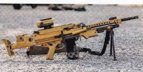
MG5, Kaliber 7,62 mm, V0 ca. 785 m/s, Kampffernung 600 m bis max. 1.000 m
