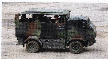
Mungo V1, 78 kW, 106 PS, max. 90 km/h, Leergewicht 3.570 kg
