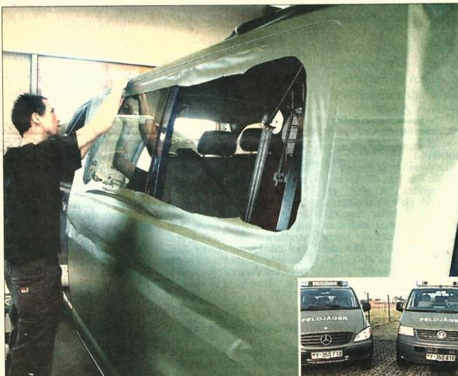
Schutz für Lack und Karosserie: Bei Intax im Gewerbegebiet Tweelbäke werden Mercedes- und VW-Busse für den Einsatz als Feldjägerfahrzeuge (kleines Bild) umgerüstet. BILDER: THORSTEN KUCHTA
